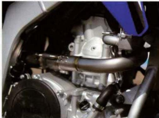
単体で手に取ってみると驚くほどの軽さを感じるチタン製エキパイ。コスト的にちょっと……という人には、ステンレス素材でサイレンサーもバンド止めのタイプ(10万2900円)も用意されている。さらにチタンEX+バンド止め、ステンEX+直づけステータイプと合計4種のラインアップがある。
