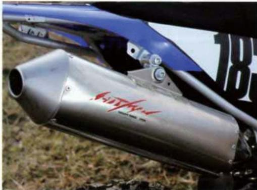
押し回しても感じる軽さ。精度も高く誰でも簡単にボルトオンできる。触媒内蔵のストリート用だが、レースでもとくに不満を感じることはなかった。
